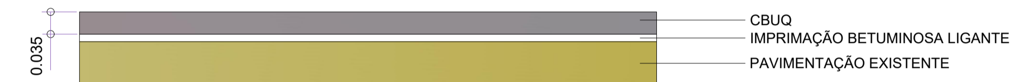
DET. DE RECAPEAMENTO Pavimento Tipo - Sem Escala
