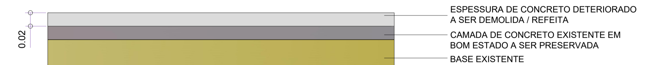
DET. DA CALÇADA A DEMOLIR/REFAZER Sem Escala
